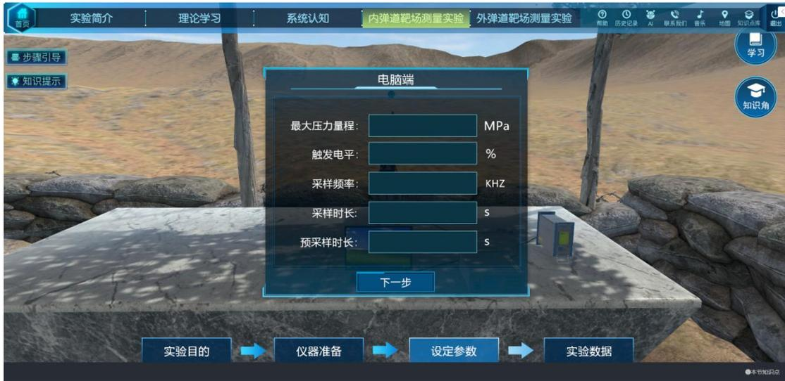
安装点火器，点击发射，展示膛内压力变化的曲线；根据曲线图填写最大膛压和初速度；
