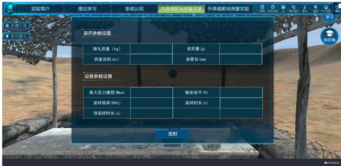
14、点击顶部菜单栏中外弹道靶场测量实验-155mm 榴弹外弹道测试，设置榴弹参数；
