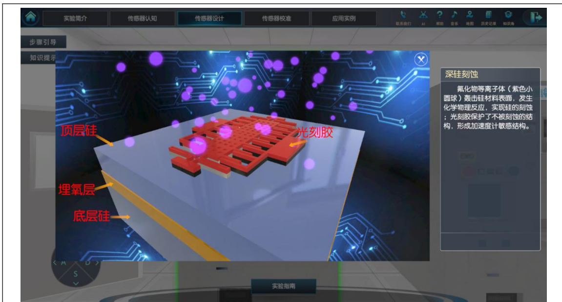
图 3-15 MEMS 深硅刻蚀工艺
